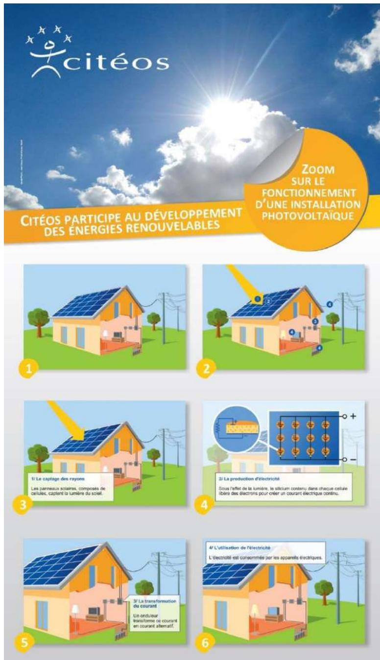
Les modules sont installés sur le pan de la toiture le plus exposé au sud (schéma 1, 2 et 3).
