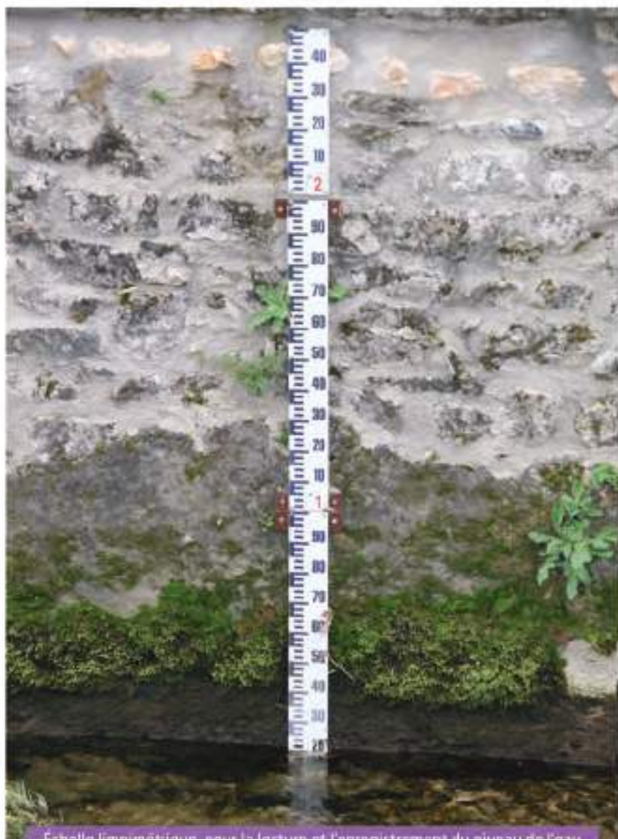
Echelle limnimétrique pour la lecture et l'enregistrement du niveau de l'eau
